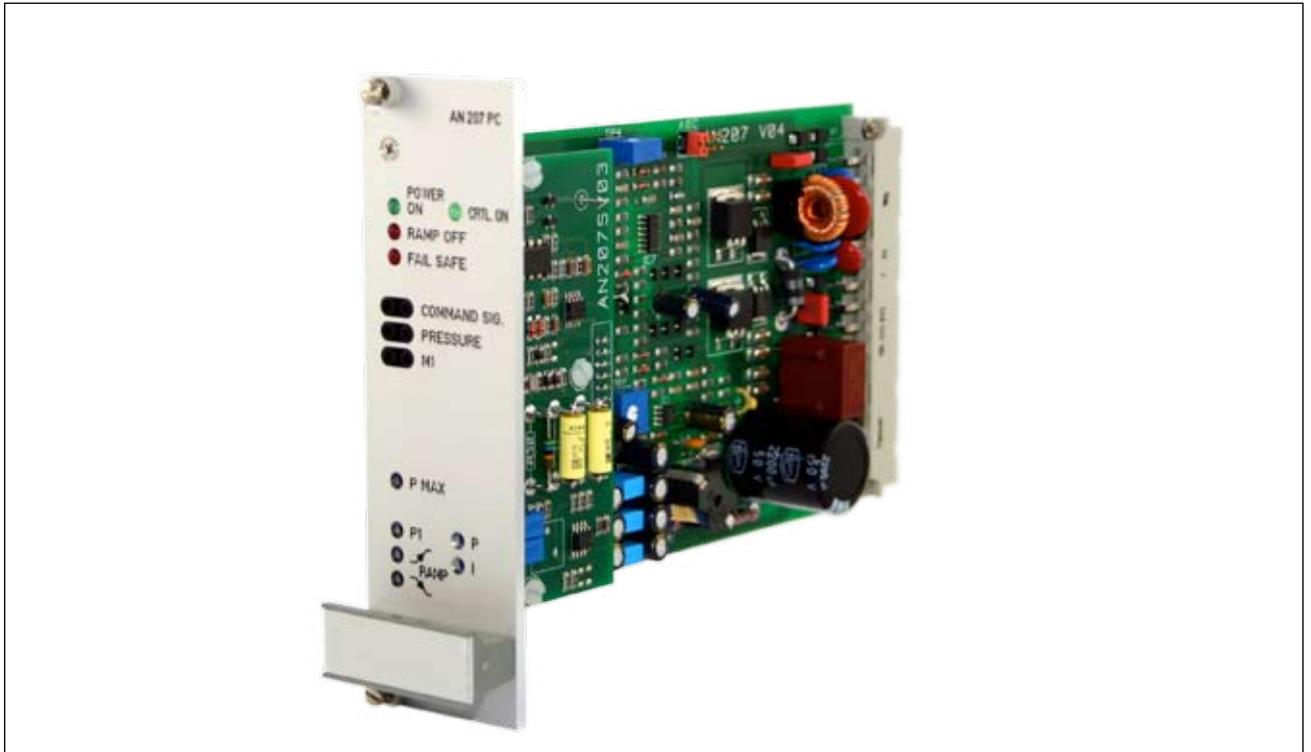
**Der Servoverstärker AN207PC ist speziell für Druckregelkreise in Verbindung mit einem Druckeinstellventil konzipiert. Durch den Einsatz eines PI-Reglers gestattet die Baugruppe eine hohe Genauigkeit zwischen Druckistwert und Sollwerteingang. Der Regler ist für die meisten Anwendungsfälle geeignet, bei denen hohe Linearität, Durchflußunabhängigkeit, Hysteresefreiheit, sowie Temperaturunabhängigkeit des eingestellten Druckes verlangt werden.**
