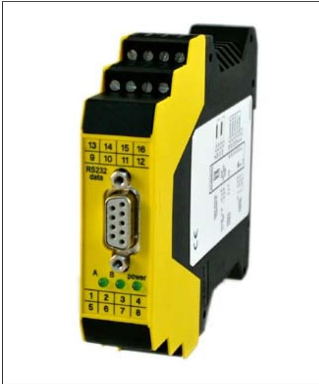
sind den 4 internen Sollwerten zugeordnet und in Stufen von 10ms von 0.01s bis 30s einstellbar. Zusätzlich lässt sich die Baugruppe auch extern über einen Analogeingang oder über den CAN-Bus ansteuern.
