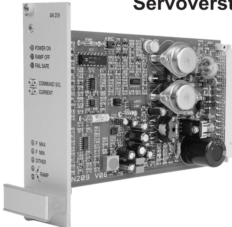
**Der Servoverstärker AN209 wurde zur Ansteuerung von Proportionaldruckeinstellventilen und Drosseln mit einem Magneten entwickelt..**
